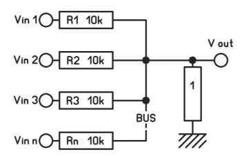
Imaginons le simple schéma ci dessus : plusieurs modulations transitent par des résistances de  $10k\Omega$  et se rejoignent sur un bus chargé à  $1\Omega$ .
