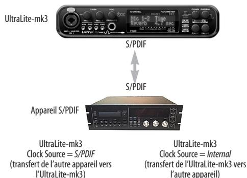
Figure 3-6 : La configuration pour synchroniser un appareil S/PDIF à l'UltraLite-mk3. La synchronisation s'effectue par l'intermédiaire de la liaison d'entrée/sortie numérique elle-même. Si vous enregistrez depuis l'autre appareil, il faut choisir "S/PDIF" comme source d'horloge pour l'UltraLite-mk3.
