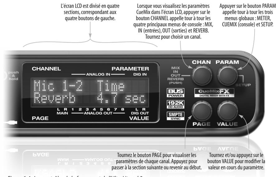
Figure 6-4 : Les contrôles de la face avant de l'UltraLite-mk3.
