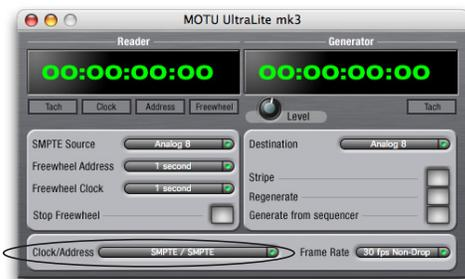
Lancez the MOTU SMPTE Console pour spécifier la cadence d'image du timecode et la durée de Freewheel. Par ailleurs, vérifiez que le champ *Clock Source/Address* est réglé sur *SMPTE/SMPTE*.
