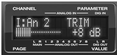
Figure 3-3 : Réglage du Trim d'entrée dans le cas d'une paire d'entrées analogiques sur jack TRS.
