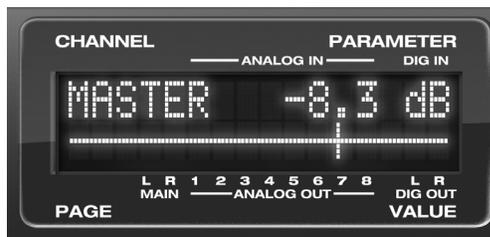
Figure 6-3 : L'écran LCD assure un retour visuel lorsque vous réglez le niveau d'écoute des sorties principales (Master).
