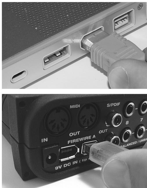
Figure 3-1 : Branchement de l'UltraLite-mk3 au port FireWire de l'ordinateur.
