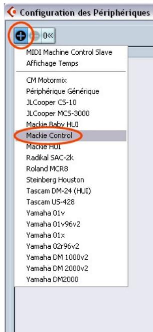
Maintenant, dans SX 1 et 2, choisissez le périphérique Mackie Control dans la section gauche où il est apparu puis l'onglet « Configuration ». Dans la section droite, choisissez, pour les ports d'entrée et de sortie MIDI « BCF2000 [01] » et cliquez sur « Appliquer ». Pour SX 3, sélectionnez simplement le périphérique dans la section gauche puis exécutez les mêmes opérations.
