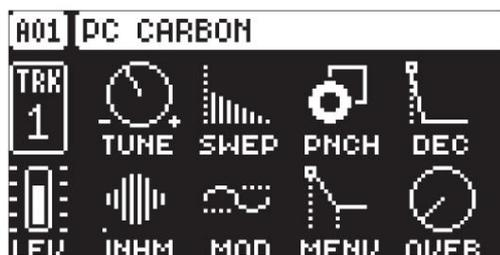
**TUNE** (Tune) compense la valeur de la note entrante. Ce paramètre est bipolaire. Un réglage de 0 laisse la hauteur inchangée.
