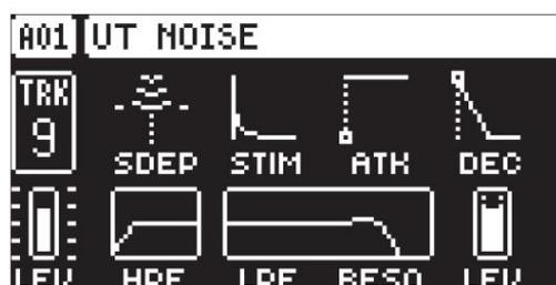
**SDEP** (Sweep Depth) définit la profondeur du balayage du filtre LP. Des balayages négatifs et positifs sont possibles.
