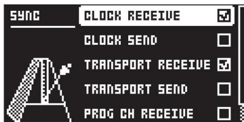
**CLOCK RECEIVE** détermine si Syntakt répond ou non à l'horloge MIDI envoyée par des appareils externes.
