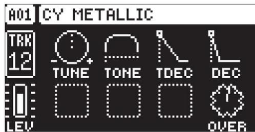
**TUNE** (Tune) définit la hauteur des oscillateurs modulés en anneau de la cymbale métallique.
