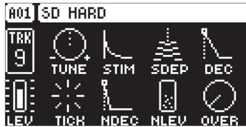
**TUNE** (Tune) règle la hauteur des oscillateurs. L'intervalle entre eux est fixe.
