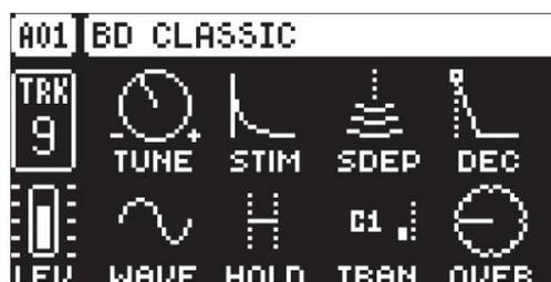
**TUNE** (Tune) règle la hauteur de l'oscillateur.
