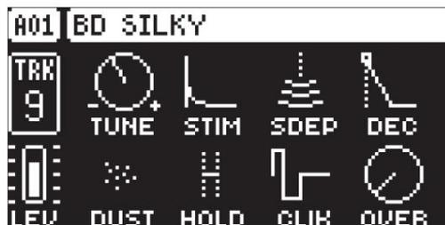
**TUNE** (Tune) règle la hauteur de l'oscillateur.
