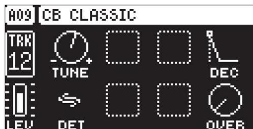
**TUNE** (Tune) règle la hauteur de base des deux oscillateurs.
