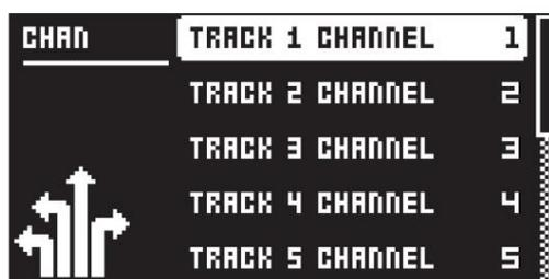
**TRACK 1–12** sélectionne le canal MIDI dédié qui est utilisé pour recevoir ou envoyer (en tournant les boutons) des données de paramètres vers ou depuis une piste audio/MIDI spécifique. S'il est configuré sur OFF, les données de paramètres ne sont ni reçues ni envoyées via MIDI.
