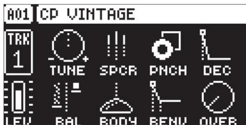
**TUNE** (Tune) compense la valeur de la note entrante. Ce paramètre est bipolaire. Un réglage de 0 laisse la hauteur inchangée.
