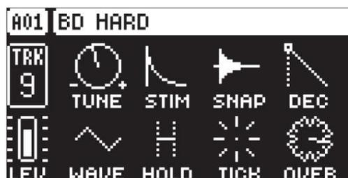
**TUNE** (Tune) règle la hauteur de l'oscillateur.
