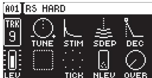
**TUNE** (Tune) règle la hauteur des oscillateurs.
