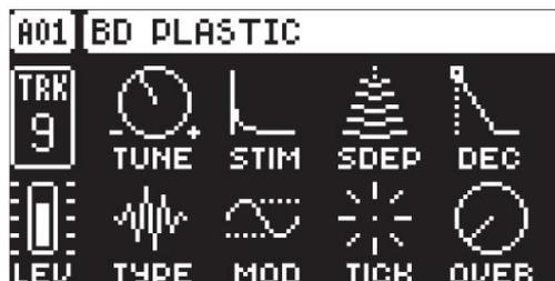
**TUNE** (Tune) définit la hauteur des deux oscillateurs en interaction.
