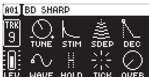
**TUNE** (Tune) règle la hauteur de l'oscillateur.
