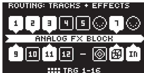
Appuyez sur **[FUNC]** + **[FX]** pour ouvrir le menu ANALOG FX BLOCK ROUTING.
