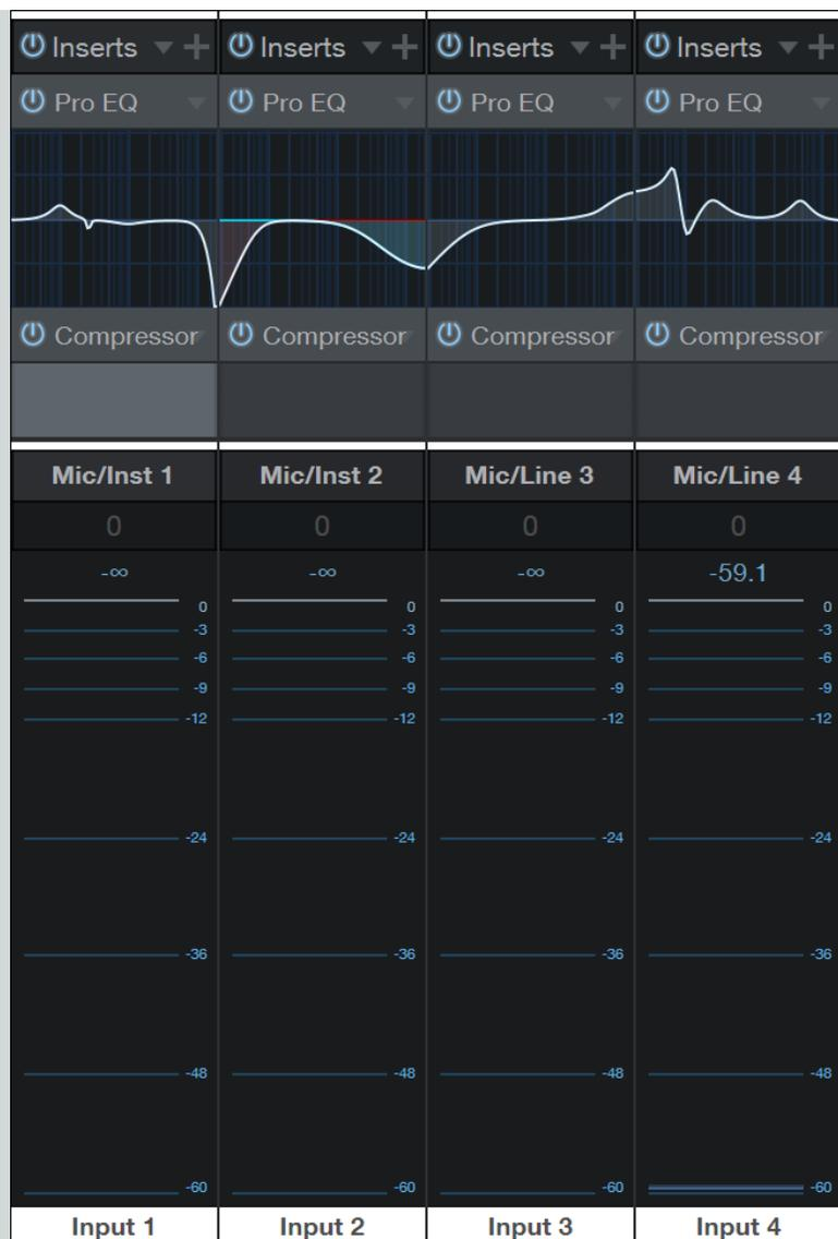
Insérez un effet dans le rack Inserts sur n'importe quel canal d'entrée, et cet effet est enregistré à l'entrée de toute piste utilisant cette source. Studio One compense automatiquement toute latence causée par les effets insérés.
