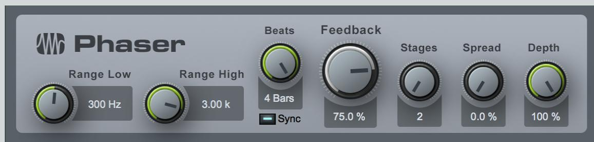
Phaser applique au signal entrant un nombre variable de filtres passe-tout en série (chacun sortant dans le suivant), conjointement à une boucle de réinjection globale. Le phaser possède un LFO pour moduler les fréquences centrales de tous les filtres passe-tout.
