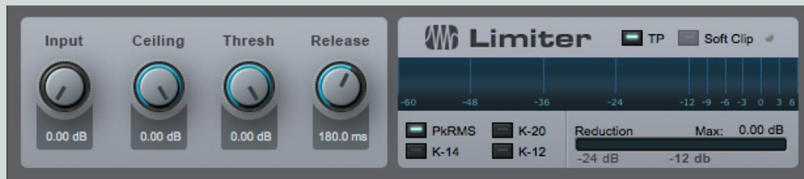
L'effet Limiter est un processeur limiteur de type brickwall avec possibilité de [mesure en système K](#). Utilisez-le pour éviter l'écrêtage de votre signal de sortie ou pour maximiser les signaux ayant des crêtes très dynamiques.
