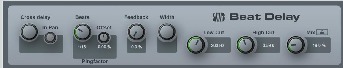
Le Beat Delay est un retard synchronisé sur le tempo avec des options de retards croisés et de réinjection filtrée. Utilisez cet effet pour accroître/changer les sensations offertes par des parties rythmiques (par exemple en ajoutant des contretemps) ou des parties de « double spatial » (par exemple un écho unique). Le Beat Delay a les paramètres suivants :
