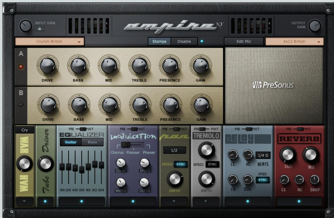
Ampire est un plug-in de modélisation d'amplificateur simple d'emploi qui dispose d'un large éventail de modèles d'amplis guitare et basse, de baffles modélisés par convolution avec des positions variables de microphone et des pédales d'effets. Utilisez cet effet pour émuler des amplificateurs de guitare et leurs baffles, et pour créer des sons plus rugueux, enrichis en harmoniques. Les paramètres suivants sont disponibles dans l'Ampire XT :
