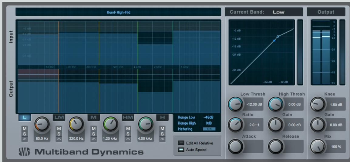
Multiband Dynamics est un compresseur/expandeur ayant cinq bandes de compression/expansion complètement indépendantes, une possibilité de réglage simultané sur toutes les bandes, et un affichage de niveau multibande. Utilisez-le pour réduire les signaux indésirables ou le bruit localisé sur une bande et pour faire ressortir ou limiter des instruments. En pratique, cet effet peut fonctionner comme un égaliseur dynamique ou pour la compression en mastering sur un mixage complet.
