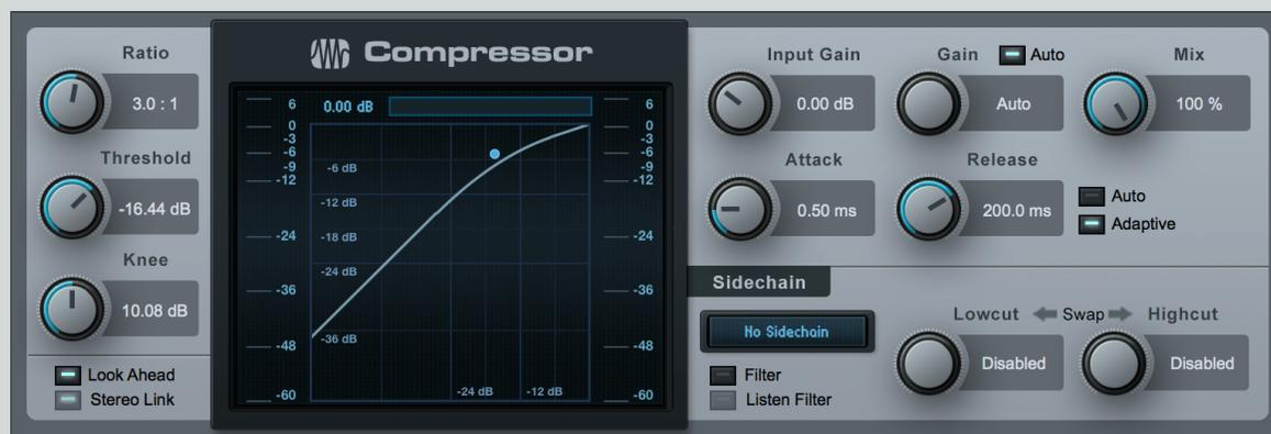
Compressor est un processeur de compression mono/stéréo complet basé sur le niveau RMS avec des circuits de déclenchement (side-chains) internes et externes. Utilisez cet effet pour réduire la plage dynamique (les crêtes) de tout signal.
