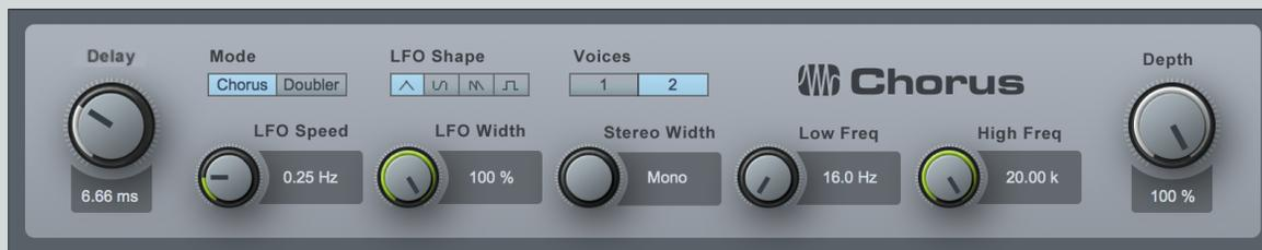
Chorus est un processeur de chorus à 1-3 voix avec en option une modulation de temps de retard de LFO et une commande de largeur stéréo. Le chorus est souvent utilisé sur les pistes vocales pour aider à créer un son de voix plus plein afin que la piste se tienne mieux dans le mixage général. Pour des raisons similaires, les parties de guitare et de synthé ont parfois recours au traitement par chorus.
