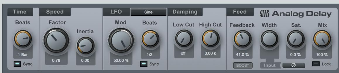
Analog Delay émule un retard à bande mono-tête avec en option synchro sur le tempo, LFO, réinjection filtrée et d'autres fonctions. Il peut servir à créer des échos qui se dégradent, des échos dont le retard et la hauteur change, et des effets flanger/chorus. Ces types de sons s'utilisent souvent en musique Dub ou en rock style années 70.
