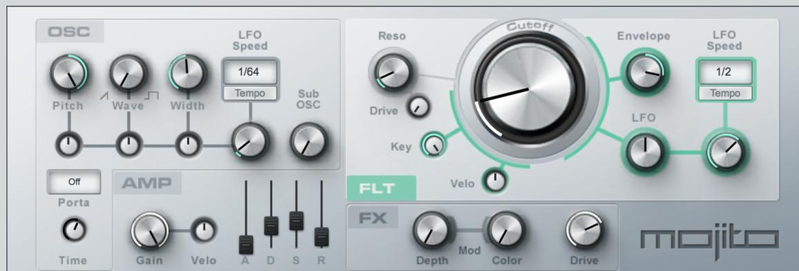
Le Mojito est un synthétiseur soustractif monophonique simple avec des effets, capable de produire une vaste palette de sons. Il modélise un synthétiseur analogique classique et dispose d'un oscillateur à faible aliasing (« repliement ») et d'une émulation de filtre 24 dB. Le Mojito peut produire des sons d'enfer, de type basse, solo et effets spéciaux.
