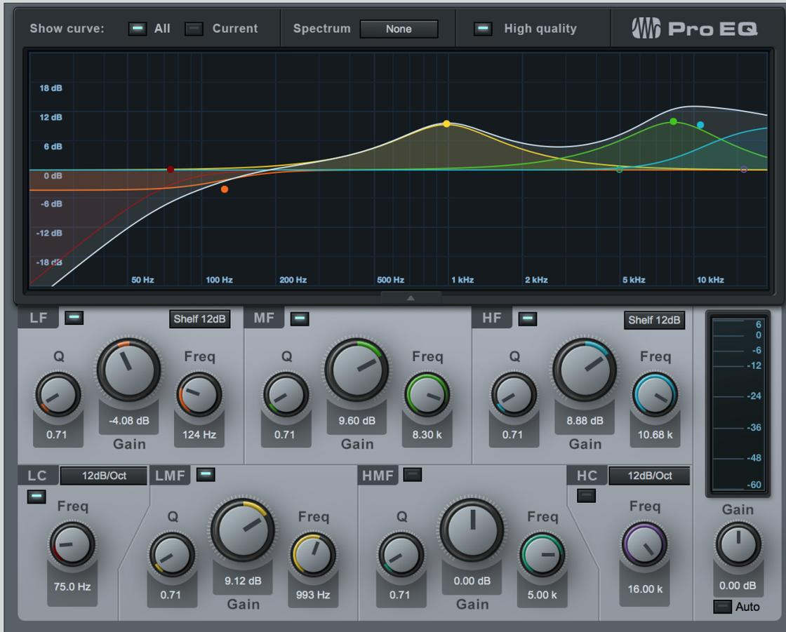
Pro EQ est un égaliseur paramétrique à sept bandes avec possibilité d'affichage du spectre, filtres variables coupe-bas, coupe-haut, multimodes basse et haute fréquence, et un réglage automatique optionnel du gain de sortie. Utilisez Pro EQ sur n'importe quelle piste mono ou stéréo pour appliquer une correction tonale précise et hautement musicale à n'importe quel signal.
