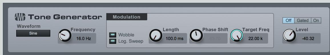
Le Tone Generator peut produire du bruit, des balayages de fréquences et d'autres types de signal couramment employés pour tester et calibrer un circuit de signal. L'oscilloscope sera souvent utilisé en conjonction avec ce générateur pour analyser les signaux retournés à la fin du circuit de signal testé ou calibré.
