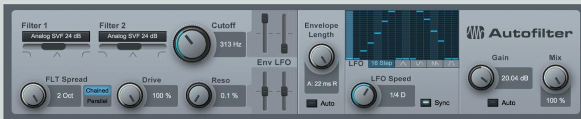
Auto Filter possède deux filtres résonants avec six modèles de filtre au choix. La fréquence de coupure et la résonance du filtre peuvent être modulées par un LFO à formes d'onde standard, un séquenceur à 16 pas et une enveloppe. Utilisez Auto Filter pour créer des effets de filtrage allant de balayages basiques de filtre à de complexes motifs de filtrage rythmique synchronisés sur le tempo.
