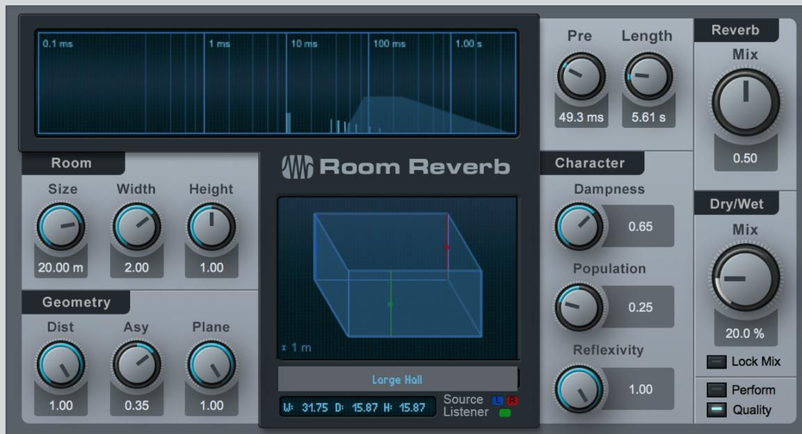
Room Reverb est une reverb de simulation de pièce qui ajuste ses paramètres internes de réverbération d'après des modèles de pièces virtuelles. Elle est destinée à l'emploi en boucle d'effet (sur un départ) ou comme effet de canal sur la sortie générale. Room Reverb dispose de paramètres et de géométries de pièce variables, d'un choix de modèles de pièce, et de commandes de population, amortissement, et régularité des surfaces.
