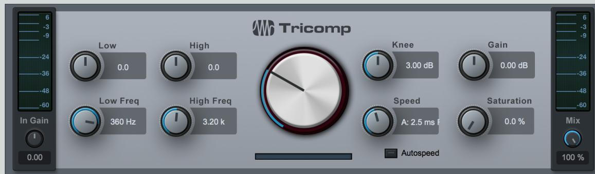
Tricomp est un compresseur à trois bandes. Il offre des réglages automatiques de seuil et de taux pour les trois bandes et une commande relative pour les bandes haute et basse, ainsi que des commandes automatiques commutables d'attaque et de relâchement. Tricomp peut servir à finaliser votre mixage ou à ajouter de la brillance ou du punch à des signaux riches en fréquences.
