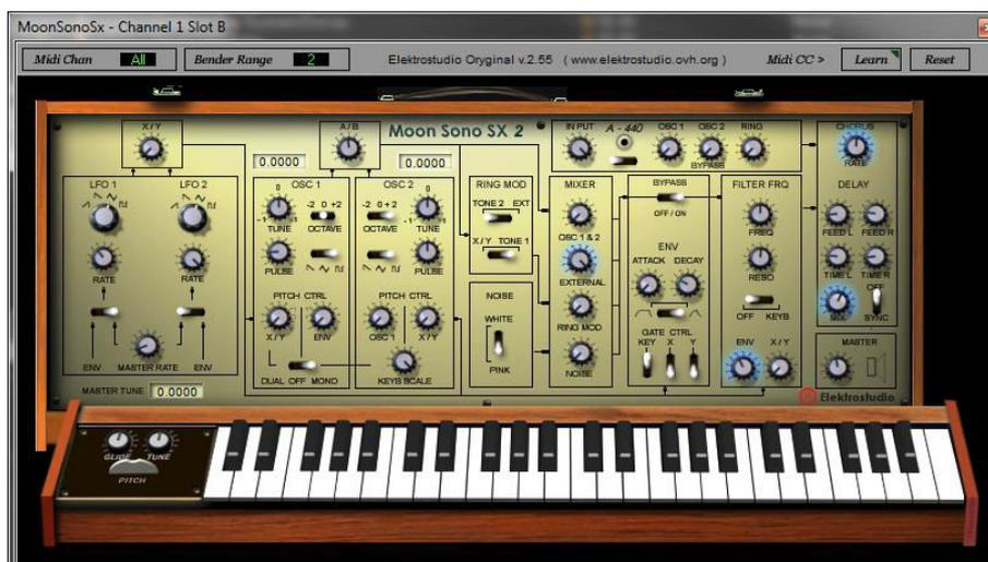
Le mode clavier duophonique vintage sur ce synthé analogique est inhabituel, et comme les instruments analogiques des années 70, il dispose d'une audio input permettant à son filtre ou au modulateur en anneau d'être utilisé comme un processeur d'effet. L'effet est activé par les notes MIDI sur le canal de réception défini dans le Mixer Slot du logiciel VFX.
