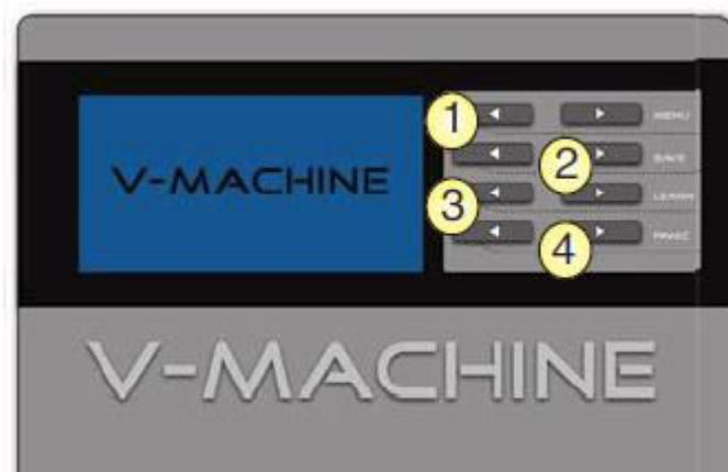
L'écran et les couples de bouton **1**, **2**, **3**, **4** permet la sélection des plugins, de leurs Preset/INSTRUMENT, de leurs PATCH et de leur réglages, par les 4 rangs de boutons gauche (précédent), et droit (suivant) :
