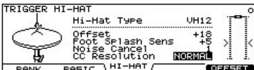
Le paramètre "CC Resolution" détermine la quantité (résolution) des données transmises par la pédale de charleston.
