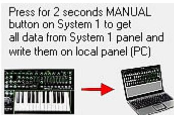
: Equivalent à appuyer 2 secondes sur le bouton **MANUAL** pour charger dans le logiciel les réglages actuels du panneau de commande hardware. Affiche en même temps la fenêtre Quick Start, la même qui s'ouvre automatiquement au lancement du logiciel
