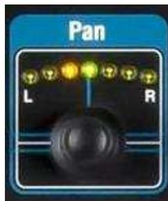
La rotation Pan contrôle devient actif quand une entrée canal **Sel** touche est active. Sa fonction dépend sur le moment choisi Maître bande de mélange:
