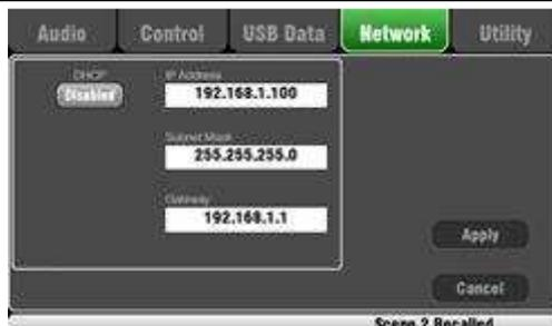
Utilisez cet écran définir l'adresse TCP / IP pour un ordinateur portable offrant un contrôle MIDI de mixer les paramètres, ou un routeur sans fil fournissant à distance en utilisant la commande Qu-Pad iPad app.
