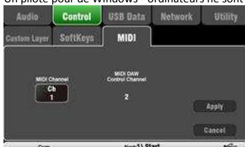
**MIDI sur TCP Réseau** - Le panneau arrière Réseau portuaire est utilisé pour la connexion à un réseau local routeur à travailler avec un iPad exécutant le **Qu-Pad** app. L'application utilise ces messages MIDI pour contrôler à distance
