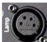
**Lampe** - Branchez dans un 4 broches col de cygne lampe à éclairer le mélangeur surface. Nous recommandons l' Allen & Heath LEDLAMP avec haut-molette gradateur.
