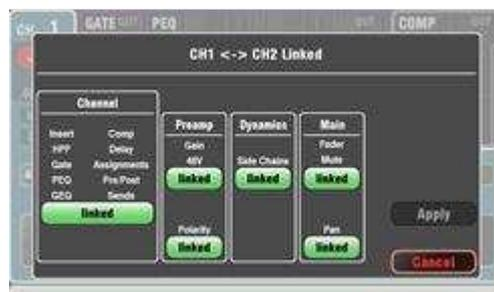
**Linking** permet de vous gangs du préampli, le traitement et l'acheminement de l'Impair Pair / mono canal paire de stéréo opération. Tous les paramètres, y compris
