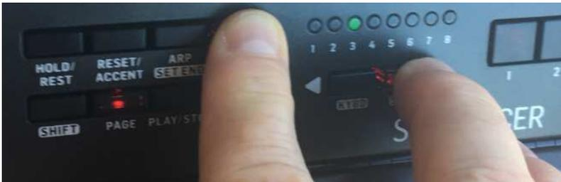
**Pour sélectionner un pattern dans une banque plus facilement**, utiliser les boutons carrés des steps. Par exemple pour la banque 2 et step 8 : Shift Bank <bouton carré 2> puis Pattern <bouton carré 8> (astuce de Suno-San).
