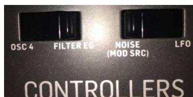
Pour s'en rendre compte, positionner dans la section « controllers » les boutons noirs sur « OSC4 » et « LFO » comme sur la photo. Mettre le LFO et l'oscillateur 4 tous les deux sur l'onde triangulaire. Via le potard « modulation mix » passer rapidement du mode « OSC4 » (potard à fond à gauche) au mode « LFO » (potard à fond à droite).
