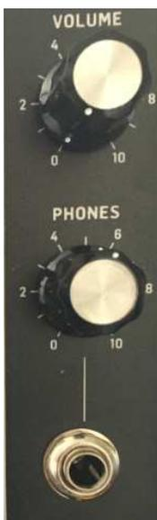
L'amplificateur est en bout de chaîne de création d'un son. Son rôle est de déterminer le volume du signal analogique qui sort de l'oscillateur pour aller au filtre. Il se compose d'un seul élément appelé VCA (voltage Controlled Amplifier). Sur un synthétiseur analogique, le VCA est réglable par le bouton de niveau (volume ou level ou gain).
