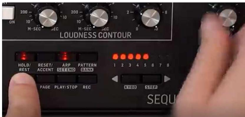
Pour choisir un type d'arpégiateur appuyer sur « shift » et appuyer sur l'un des 8 programmes
