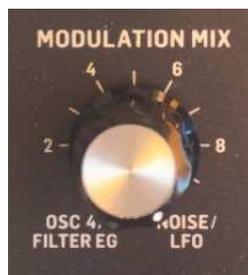
Le filtre est modulé par le mixage de modulation « Modulation mix ». Si le potard est positionné complètement à gauche la modulation est réalisée par l'oscillateur 4 ou le filtre d'enveloppe (selon précédent choix), s'il est complètement à droite la modulation est réalisée par le bruit ou le LFO (là encore selon choix précédent). Entre deux tous les choix de mixages de modulations sont possibles avec les deux sources choisies.
