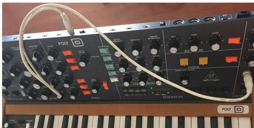
Connecter « velocity » au filtre « filter » pour donner de la brillance au son. Ajuster à l'aide du potard arrière cranté de 0 à 10 « velocity »
