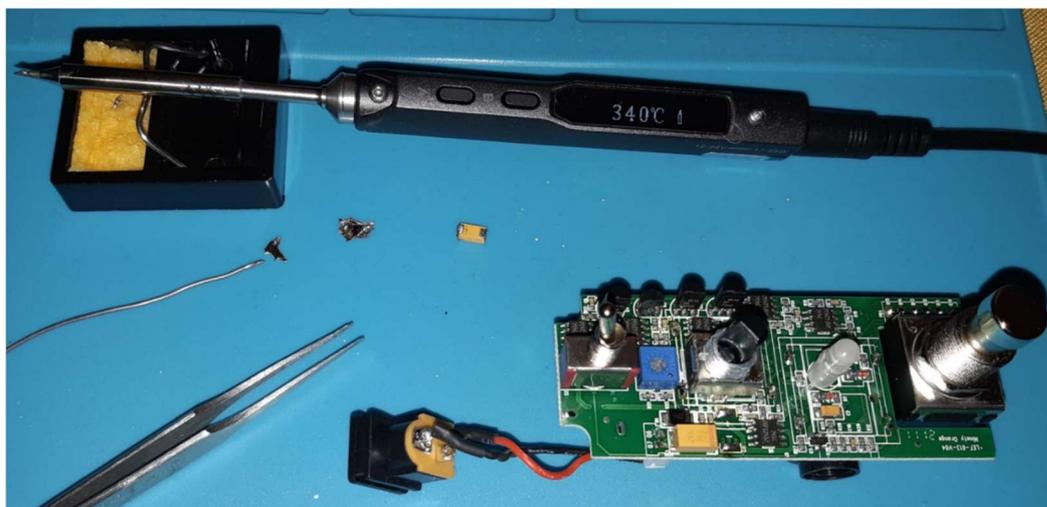
Puis on remplace par un autre condensateur polarisé, comme je l'ai dit, j'ai fait des tests en acoustique, avec un 1uF/25V on module assez haut j'ai donc remplacé par un 4.7uF/50V qui me conviens plus dans l'effet que je recherche.
