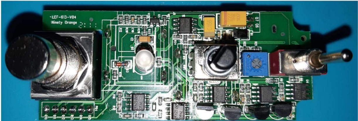
Une fois hors du boîtier on peut accéder aux éléments du circuit. Comme on peut le voir sur cette image le circuit 741C **U6** est l'oscillateur TBF de modulation de phase. Le 'gros' condensateur jaune **C11**, marqué 156 (15 microfarads =  $15 \times 10^{-6}$ ) et à la base de la génération du signal TBF.
