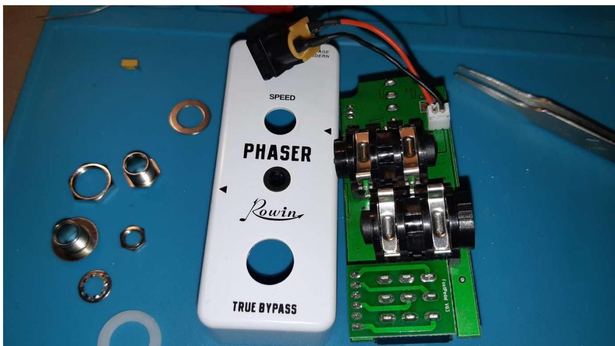
Il faut un peu forcer pour sortir le PCB du boîtier, faire levier avec un tournevis pour délicatement le sortir complètement du boîtier métallique.
