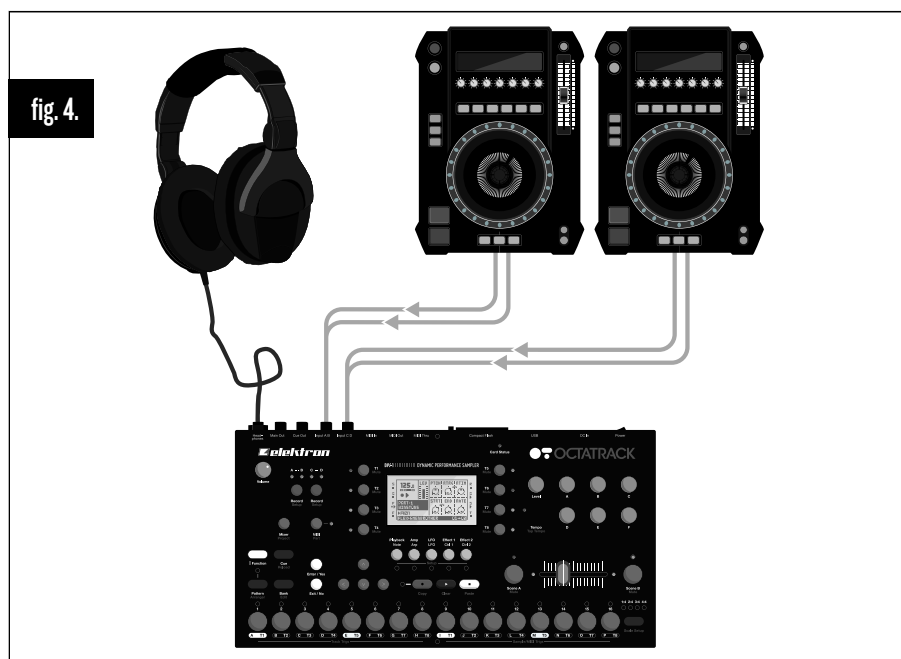
Fig 4. Deux consoles de DJ sont connectées aux entrées de l'Octatrack. La sortie casque est définie pour surveiller les sorties main et cue. Le crossfader est affecté au contrôle de l'équilibre de sortie principale entre les deux signaux entrants. L'Octatrack peut mélanger entre les consoles de DJ en suivant la méthode DIR méthode ou la méthode des machines Thru.
