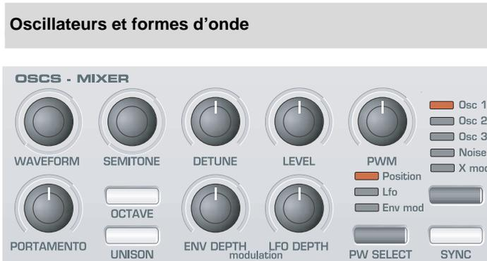
L'oscillateur est vraiment le cœur du synthétiseur. Il génère une onde électronique (qui crée les vibrations). Cette *forme d'onde* est produite à une hauteur musicalement contrôlable, initialement déterminée par la note jouée sur le clavier ou contenue dans le message de note MIDI reçu. Le timbre initial caractéristique de l'onde est déterminé par la forme de cette onde.
