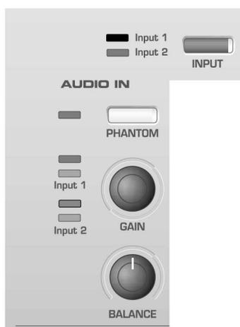
Cela réglera le gain du pré-amplificateur à un niveau correct pour le microphone afin qu'il n'y ait pas de distorsion, ni un trop faible volume à l'enregistrement.
