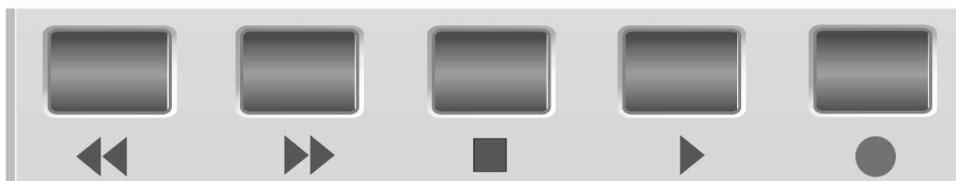
Les boutons de transport peuvent être définis de la même façon que tout autre bouton programmable en **mode Template Edit**. Toutefois, ils sont idéalement adaptés au pilotage des séquenceurs ou enregistreurs. Par conséquent, ils peuvent aussi être affectés à la transmission de commandes MIDI MMC (MIDI Machine Control).
