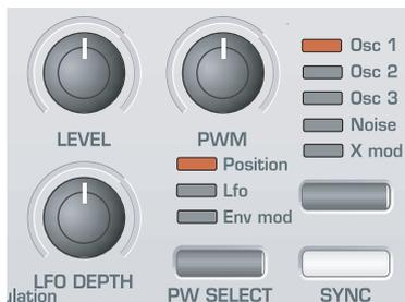
Certains synthés comme le KS 5 Novation ont une section Mixer indépendante en façade. Sur le KS, une seule commande LEVEL dans la section OSC/MIXER sert à régler les niveaux des oscillateurs et du générateur de bruit. Chacune des sources peut voir son amplitude (niveau de volume) être ajustée indépendamment et être mélangée avec les autres pour former une nouvelle onde harmoniquement plus complexe.
