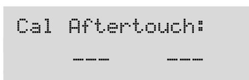
Le numéro sur le côté droit est le réglage de sensibilité. Il se règle manuellement avec l'encodeur DATA / VALUE.
