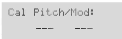
Le joystick est déplacé de l'extrême gauche à l'extrême droite. Les chiffres sous le mot "Pitch" indiqueront 0 à 255. Le joystick est ensuite déplacé de l'extrême haut à l'extrême bas. Les chiffres sous le mot "Mod" afficheront 0 à 128.
