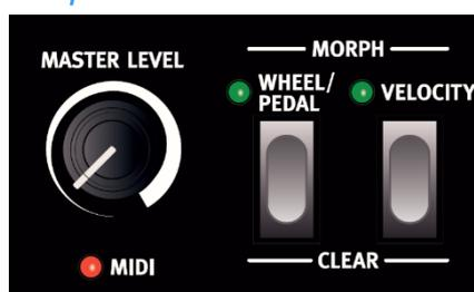
Le « morphing » est une puissante méthode pour contrôler un ou plusieurs paramètres en temps réel, grâce à la **molette de modulation** ou à la dynamique du clavier. Un « morphing » est très facile à configurer.
