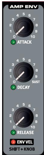
L'enveloppe d'amplificateur est une enveloppe « ADR/ASR » polyphonique servant à contrôler la façon dont évolue l'amplitude ou niveau du son au cours du temps.
