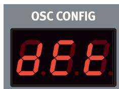
Detune est une configuration à 2 oscillateurs dans laquelle l'oscillateur 2 peut être soit légèrement désaccordé soit accordé par intervalles d'un demi-ton.
