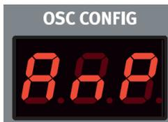
L'amplitude de l'oscillateur 1 est modulée par une onde sinusoïdale issue de l'oscillateur 2.
