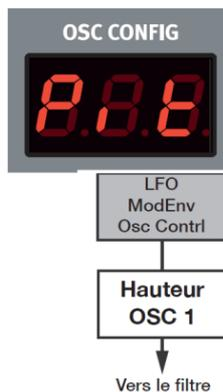
Configuration a oscillateur unique dont la hauteur peut être modulée par l'enveloppe de modulation, le « LFO », réglée ou traitée par morphing
