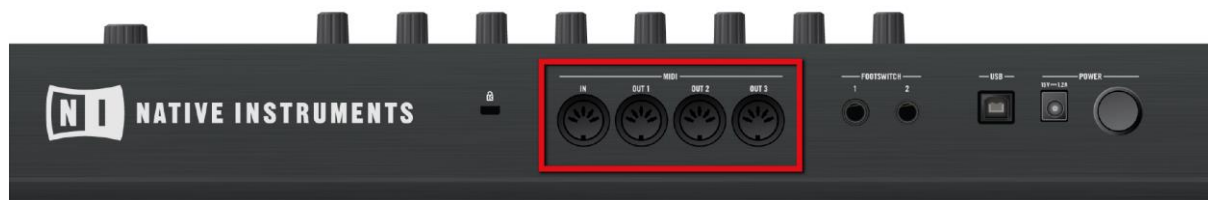
Le panneau arrière du contrôleur MASCHINE avec ses ports MIDI IN et MIDI OUT.
