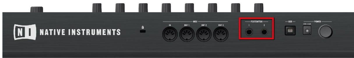
Les entrées footswitch situées à l'arrière de votre contrôleur.
