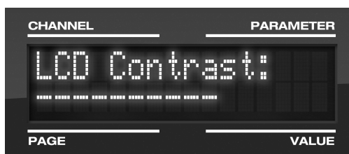
Figure 6-8 : En mode Setup, l'écran LCD affiche le nom du paramètre de configuration dans la ligne du haut, et la valeur en cours dans la ligne du bas.
