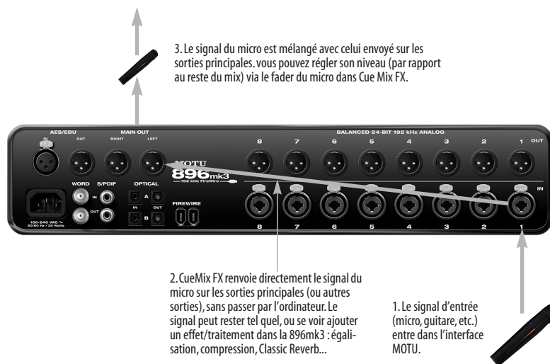
Figure 10-2 : Le schéma indique le parcours suivi par le signal lorsque vous utilisez la fonction d'écoute sans latence de CueMix FX. Notez que cette méthode n'utilise pas les plug-ins d'effets tournant dans votre logiciel audio hôte. Mais rien ne vous empêche d'appliquer au signal d'entrée les effets et traitements disponibles via le DSP intégré à la 896mk3 : réverbération, égalisation et/ou compression
