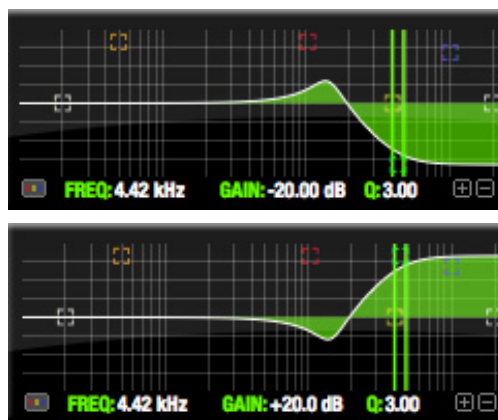
Figure 11-19 : Suroscillation dans les aigus, cut et boost en mode Shelve.
