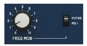
Sélectionne le type et la quantité de modulation de fréquence appliquée aux VCOs esclaves uniquement.
