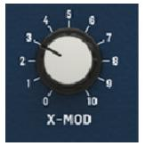
Détermine la quantité de modulation croisée dans les modes X-MOD ou S&X (donc la puissance de l'effet). Il n'a aucun effet en mode SYNC
