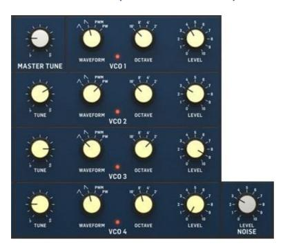
L'oscillateur à fréquence réglée par variation de tension (VCO) est la principale source de son d'un synthétiseur et détermine la hauteur et la qualité tonale de base, ou timbre, de tous les sons produits.
