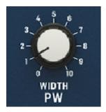
La commande PW WIDTH fait varier manuellement la largeur d'impulsion, donc sa durée, pour les formes d'onde VCO "PW" sélectionnées dans la section VCO.
