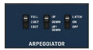
L'arpégiateur du MonoPoly séquence automatiquement, c'est-à-dire joue en séquence, l'une après l'autre, les notes individuelles d'un accord maintenu enfoncé à n'importe quelle vitesse désirée et dans trois modèles différents.
