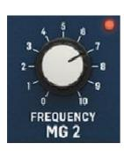
Le générateur de modulation produit un triangle supplémentaire permettant d'ajouter un effet de modulation complémentaire et qui peut fonctionner simultanément à différents niveaux de réglages.
