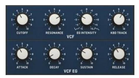
Le filtre à tension contrôlée (VCF) est un outil puissant pour façonner le timbre des ondes fondamentales produites dans le bloc des oscillateurs VCO en éliminant certaines harmoniques et en accentuant d'autres.
