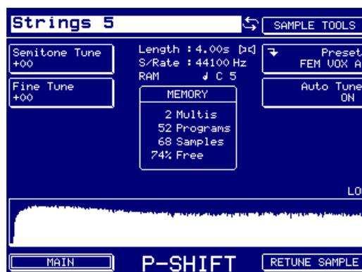
Ce processus consiste à manipuler la hauteur du son - le "facteur de stretch" de PITCH SHIFT est décrit en termes de transposition. Par exemple, si vous avez un sample en do que vous désirez utiliser dans une transposition au clavier d'un morceau où tout se retrouve transposé d'un ton vers le haut, en ré, entrez une valeur de SEMITONE TUNE de +02.
