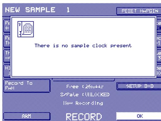
Vous pouvez soit brancher une source de wordclock externe, soit rétablir le paramètre SYNC SOURCE (dans UTILITIES / SYSTEM SETUP) sur INT 44.1kHz ou INT 48kHz.
