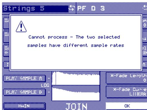
Il n'y a rien à faire pour supprimer ce problème. Même si vous essayez de rééchantillonner l'un d'eux à une fréquence différente et que vous essayez à nouveau la fonction JOIN, le message suivant apparaîtra (Traitement impossible - Les deux échantillons sélectionnés ont des accords différents) :
