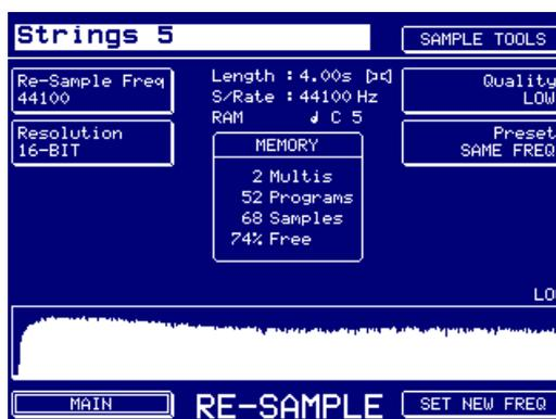
Le processus de RE-SAMPLE permet de modifier la fréquence d'échantillonnage d'un sample. Cela peut être utile pour économiser de la mémoire, mais aussi pour réduire "créativement" la qualité d'un son. Les paramètres disponibles sont :
