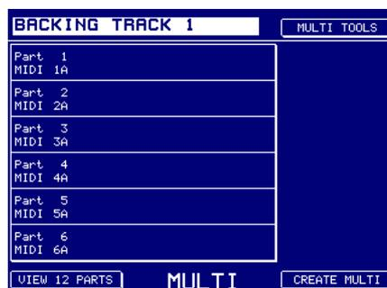
Le nouveau Multi est alors initialisé, et les Parts 1 à 16 assignées aux canaux MIDI 1A à 16A, tandis que les Parts 17 à 32 le sont aux canaux MIDI 1B à 16B. Si vous avez créé un multi comprenant 64 parts, les parts 33 à 48 se verront assignées aux canaux MIDI 1A à 16A et les parts 49 à 64 aux canaux MIDI 1B à 16B – même type d'assignation pour un multi contenant 128 parts. Vous pouvez à présent remplir ces parts avec les sons que vous désirez jouer.
