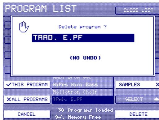
La case à cocher SAMPLES, en F14, vous permet de sélectionner si vous désirez aussi supprimer les samples associés au programme sélectionné. Si cette case est cochée, les samples seront supprimés.
