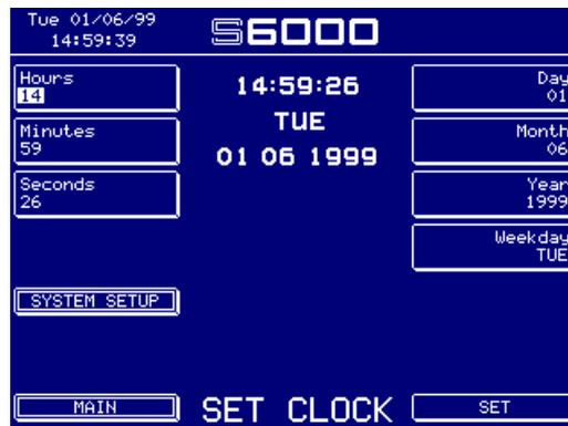
L'heure où vous êtes entré dans cette page apparaît gelée au centre de l'écran (l'heure continue de tourner sur le sampler, on le voit dans le coin supérieur gauche de l'écran). Réglez les paramètres corrects pour la date et l'heure, puis, au moment approprié, appuyez sur SET (F16) pour mettre effectivement l'horloge du sampler à l'heure.
