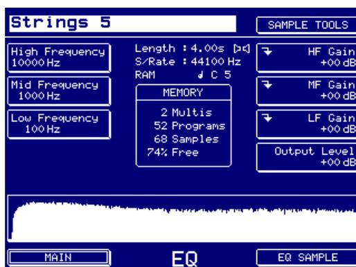
Vous pouvez accéder à trois bandes (deux semi-paramétriques et une paramétrique) d'égalisation. Chaque bande est pourvue d'un gain et d'une fréquence variables, et la fonction 'window' dans les paramètres GAIN, en bas à droite de l'écran, donne accès à des fonctionnalités supplémentaires.
