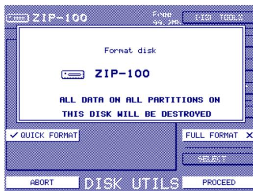
Vous avez le choix entre effectuer un formatage rapide **QUICK FORMAT** ou complet **FULL FORMAT**. L'option **FULL FORMAT** est recommandée pour les disques neufs ou ayant servi sur un autre appareil (par exemple, un disque ayant été utilisé sur un ancien sampler Akai). L'option **FULL FORMAT** est évidemment moins rapide, mais elle configure correctement le disque. L'option **QUICK FORMAT** peut servir à reformater un disque MS-DOS.
