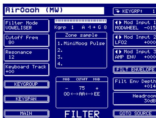
Deux exemples de filtres de type "Voyelle", permettant d'obtenir des effets d'articulation de voyelles, comme l'indique leur nom (vowel). C'est la molette de modulation qui permet de contrôler l'effet.
