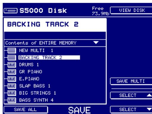
Dans cet exemple, vous étiez en train de travailler sur le Multi BACKING TRACK 2 lorsque vous avez appuyé sur SAVE. C'est donc l'élément qui est sélectionné pour être sauvegardé. Si vous aviez travaillé sur un Sample ou un Programme, c'est l'élément correspondant qui serait sélectionné pour être sauvegardé.
