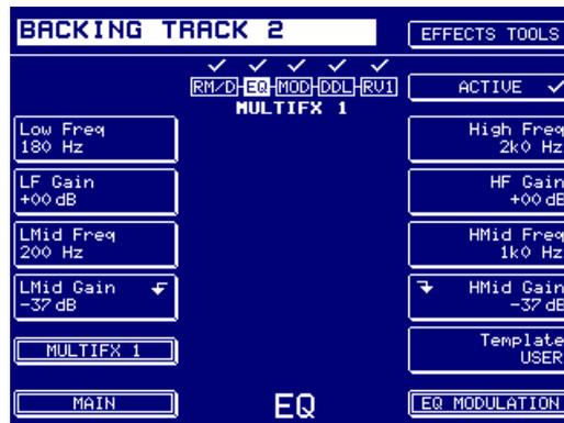
La section d'égalisation des deux voies multieffets est constituée d'un égaliseur quatre bandes offrant un contrôle passe-bas sur les fréquences basses, deux contrôles passe-bande sur les fréquences moyennes et un contrôle passe-haut des fréquences élevées. Soit :
