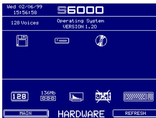
D'un coup d'œil, vous savez quelle quantité de RAM est installée, si le processeur d'effets EB20 est présent (S5000 seulement), si la carte d'extension de voix est présente (S5000 seulement) et combien de voix sont disponibles, si l'option ADAT est installée, si un clavier est relié au sampler et quels lecteurs sont connectés. Les éléments dont l'icône apparaît barrée d'une croix ne sont pas installés/connectés.
