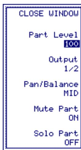
L'édition des paramètres apparaissant dans cette fenêtre s'effectue de la manière habituelle : il suffit d'appuyer sur une des touches situées en regard, puis de modifier leur valeur avec la molette DATA. Pour refermer la fenêtre, il suffit d'appuyer sur CLOSE WINDOW.
