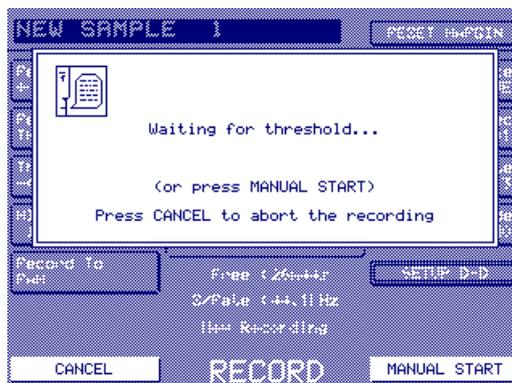
Le Sampler attend alors que le signal dépasse le niveau de seuil (ou reçoive une Note On MIDI). Si vous préférez, vous pouvez utiliser le démarrage manuel "MANUAL START". Quelle que soit la méthode utilisée, vous obtiendrez l'écran de progression suivant :
