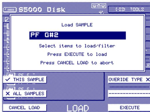
Ces cases à cocher permettent de ne charger que le sample sélectionné ou tous les samples se trouvant dans le dossier en cours.
