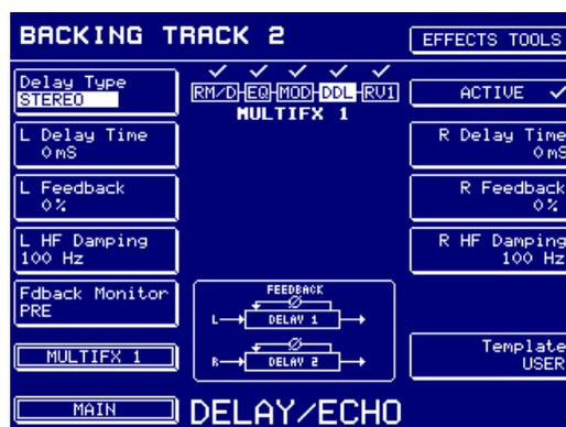
Les paramètres sont identiques à ceux des effets de délais de type mono et crossover, à part que vous pouvez contrôler indépendamment sur les deux canaux les temps de délai, la réinjection et l'atténuation des aigus. Le paramètre PING PONG n'est pas disponible dans ce type d'effet de délai.
