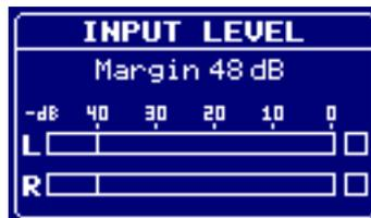
Ils ont été calibrés de manière très précise afin d'indiquer les niveaux avec beaucoup d'exactitude. Dès qu'un signal entre dans le Sampler, ces vumètres bougent. A leur droite, une petite case indique s'il se produit un écrêtage.
