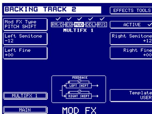
Il s'agit d'un pitch shifter permettant d'agir indépendamment sur la hauteur des sons du canal gauche et droit. Les paramètres sont les suivants :
