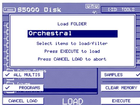
Les cases à cocher en F6, F7 et F14 permettent de désactiver certains éléments du chargement. Par exemple, vous pouvez ne charger que les Programs et les Samples d'un dossier, dans ce cas, vous pouvez désactiver le chargement des Multis en appuyant sur F6.
