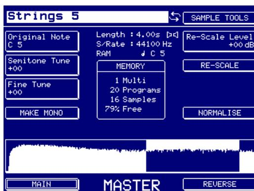
La forme d'onde du sample apparaît en bas de l'écran. La zone apparaissant en vidéo inversée correspond à la partie bouclée du sample.
