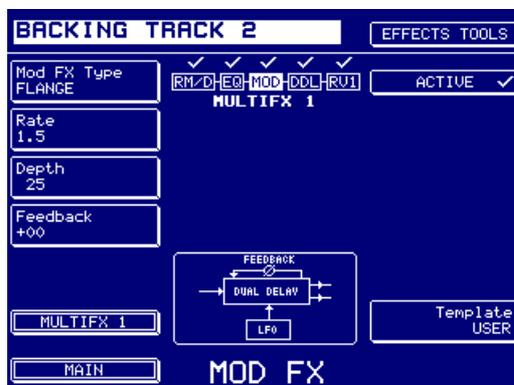
Cet effet utilise une double ligne de délai dont les canaux gauche et droit sont "balayés" en opposition de phase (quand l'un monte, l'autre descend), afin de produire des effets de flanger stéréo riches.
