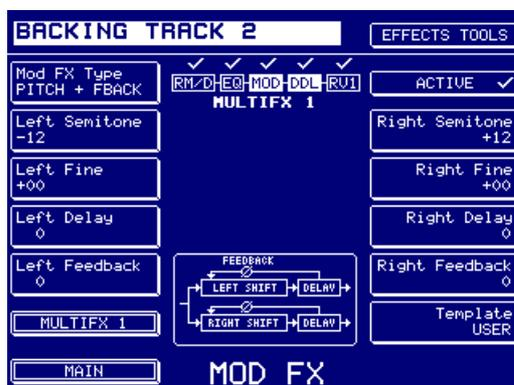
Cet effet ressemble beaucoup à PITCH SHIFT, avec une ligne de délai supplémentaire, insérée dans la réinjection de signal :
