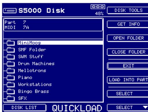
C'est une variante du mode de chargement principal (LOAD). Dans cet exemple, nous sommes dans le "répertoire racine" d'un disque appelé Disque S5000. Imaginons que nous voulons charger quelque chose en provenance du dossier SWM STUFF.
