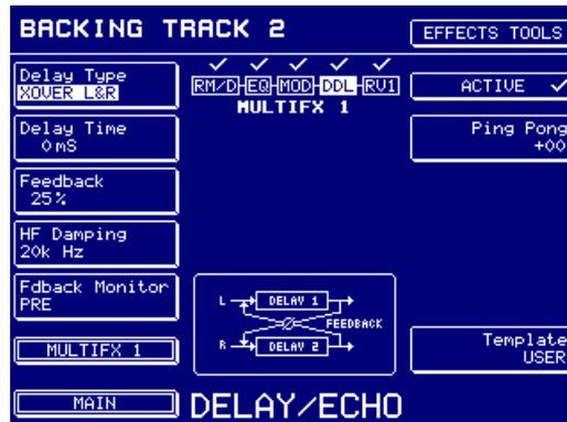
Les paramètres sont identiques à ceux des effets de délais de type mono, à part que par suite de l'emploi de deux lignes de délai, les durées maximales sont réduites de moitié (335 ms).
