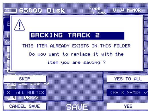
Appuyer sur YES remplacera l'élément sur le disque par celui que vous sauvegardez. Appuyer sur NO conservera l'original sur le disque et le nouvel élément ne sera pas sauvegardé.
