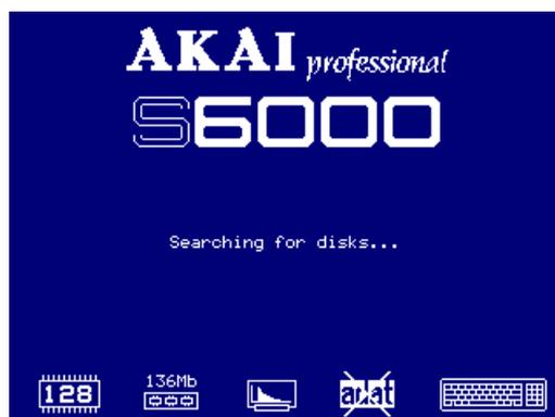
Les icônes apparaissant dans la partie inférieure de l'affichage indiquent le type de configuration installée.
