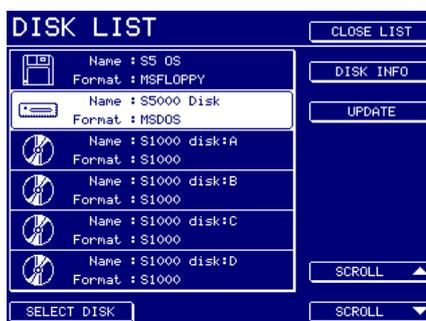
Pour sélectionner le disque de votre choix, il suffit d'appuyer sur la touche se trouvant à gauche de son nom, puis d'appuyer sur SELECT DISK (ou de faire un "double-clic" sur la touche). Il sera alors sélectionné, puis vous retournerez automatiquement dans la page QUICKLOAD, où son contenu apparaîtra. Pour charger les sons dans la Part sélectionnée, procédez comme expliqué ci-dessus.
