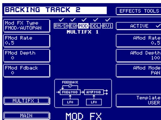
Cet effet permet d'effectuer des modulations de fréquence et/ou d'amplitude, permettant d'obtenir toutes sortes de vibratos, d'auto-pans, de trémolos et d'effets Doppler. Les paramètres sont :
