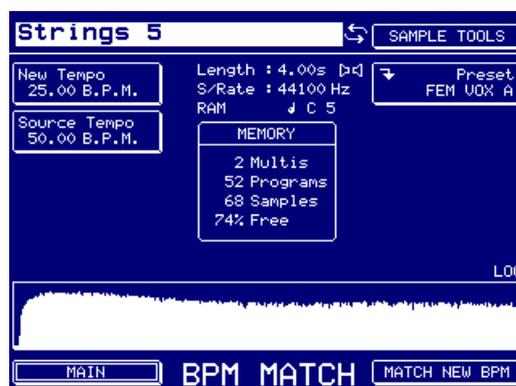
BPM MATCH est un dérivé de l'algorithme de timestretching. Les paramètres sont d'ailleurs pratiquement identiques à ceux de la fonction TIMESTRETCH, avec l'addition d'un paramètre SOURCE TEMPO.
