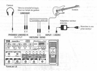
Reliez les prises OUTPUT L/MONO et R (7.6) du ToneLab LE aux entrées de la console de mixage, de l'enregistreur ou de l'amplificateur. Au besoin, vous pouvez aussi insérer un processeur d'effet externe. Il suffit alors de brancher la prise SEND à l'entrée du processeur et la prise RETURN à la sortie.
