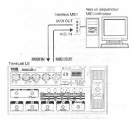
Si vous utilisez le ToneLab LE avec un séquenceur MIDI ou le logiciel Sound Editor, les données doivent pouvoir circuler dans les deux sens. Il faut donc brancher la prise MIDI OUT du ToneLab LE à la prise MIDI IN du dispositif MIDI externe et la prise MIDI OUT de ce dernier à la prise MIDI IN du ToneLab LE avec des câbles MIDI.
