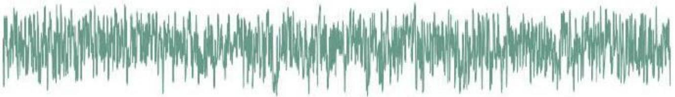
Le paramètre contrôle la fréquence d'un simple filtre passe-bas/passe-haut 1-pole dans lequel est envoyé un bruit blanc. De 0 à 63, des hautes fréquences sont progressivement ajoutées. De 63 à 127, les basses fréquences sont progressivement enlevées. Cette oscillateur est parfait pour des percussions ou des effets sonores.
