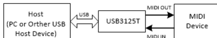
La puce est facile à utiliser et le circuit de travail nécessite au moins un condensateur de découplage et aucun circuit oscillateur à cristal n'est requis. Par rapport aux puces existantes, les circuits périphériques peuvent réduire considérablement les coûts.
