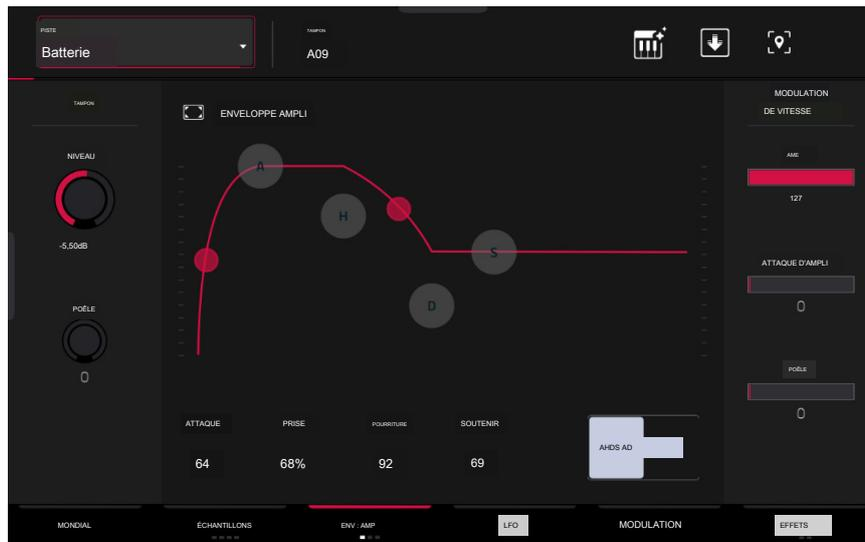
Le premier onglet Enveloppe contient l'enveloppe de modulation d'amplitude.
