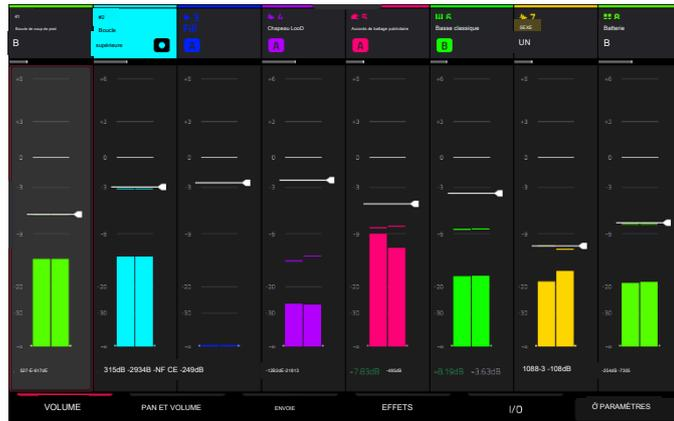
Appuyez sur un curseur de niveau, puis utilisez la molette de données ou les boutons +/- pour régler le niveau de volume de la piste, du retour ou de la sortie principale actuellement sélectionnés. Vous pouvez également appuyer et faire glisser un curseur de niveau pour régler le niveau de volume.
