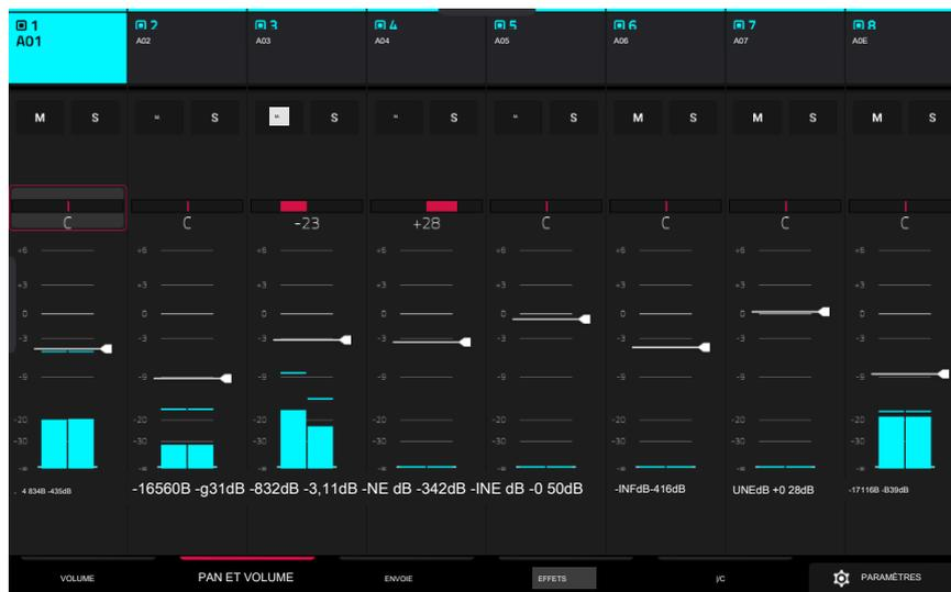
Utilisez les boutons M et S pour couper et mettre en solo le pad.
