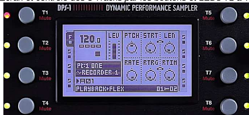
Ecran et contrôle des 8 Tracks par les boutons et LEDs T1 à T8
