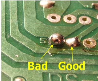
Un exemple d'un joint "sec" - la soudure n'a pas coulé, elle a perlé pour former une goutte de soudure autour du fil
