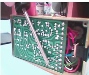
Quand vous travaillez sur les pédales, ou n'importe quel autre appareil électronique, il est toujours conseillé de "décharger les condensateurs", ce qui équivaut à les vider de toute charge électrique,
