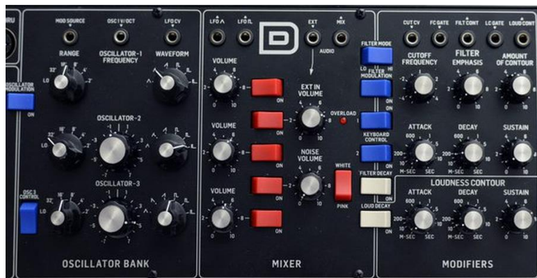
Le design ne pouvait pas être plus classique: 3 OSC, un mixeur, un filtre et deux enveloppes.
