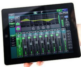
**Qu-Pad** est un outil de mixage ui donne la liberté à l'ingénieur du son de se déplacer dans la salle ou sur scène, d'écouter le son et de contrôler tous les aspects du mixage là où c'est nécessaire. Qu-Pad nécessite le mot de passe d'administrateur du mélangeur s'il y en a un.
