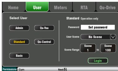
Les Qu disposent de plusieurs fonctions qui protègent le système d'accès non autorisés au mélangeur ou à l'appli, et qui restreignent le contrôle accordé à certains opérateurs. Par exemple, pour éviter qu'un opérateur régulier ne change la configuration ou pour limiter le contrôle par le personnel non technicien du bar aux seules musiques d'ambiance et annonces.
