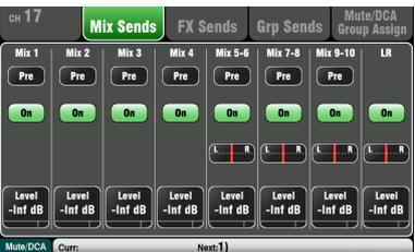
**Écran Routing** – Cet écran vous permet de travailler avec les départs d'un canal vers tous les mixages, ou d'accéder aux réglages globaux et aux options de routage pour les mixages. Pour travailler avec les départs de tous les canaux vers un mixage, utilisez les touches **Mix**.
