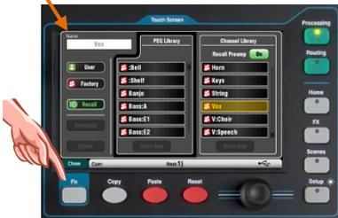
**Channel Library** – Ce preset de bibliothèque de canal rappelle tous les paramètres de traitement (Gate, PEQ, Comp, Delay) du canal d'entrée. Activez « Recall Preamp » pour inclure aussi les réglages de préampli (gain, atténuateur, 48 V, phase). Les bibliothèques de canal ne comprennent pas les réglages de couplage ou d'atténuation automatique (Ducker).
