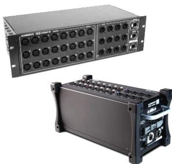
**AudioRack** – Tous les modèles sont compatibles avec les AudioRacks optionnels Allen & Heath AB168, AR2412 et AR84 qui procurent des entrées micro et sorties ligne déportées reliées au mélangeur par un « multipaire numérique » sur Cat5 pouvant atteindre 100 m de long. Deux AudioRacks peuvent être connectés, le second comme extension du premier.
